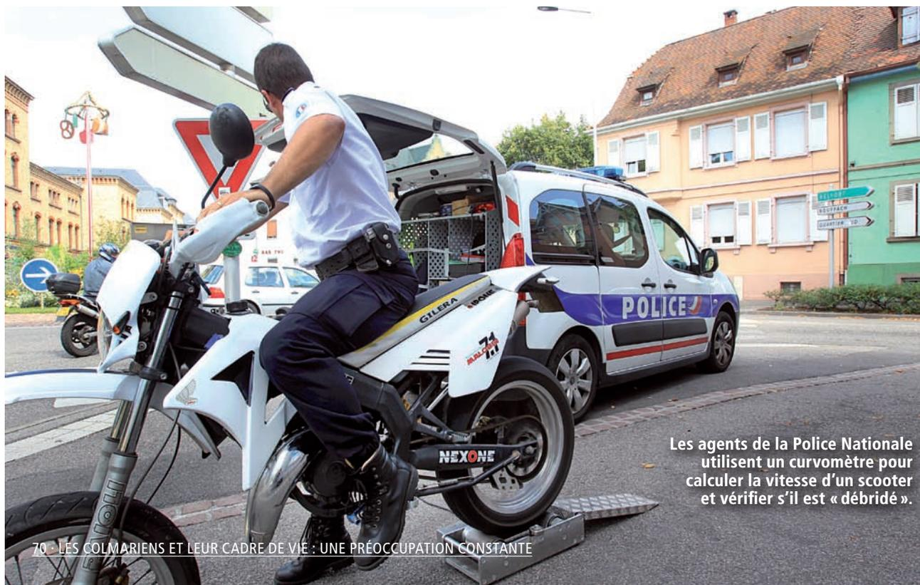
Les agents de la Police Nationale utilisent un curvomètre pour calculer la vitesse d'un scooter et vérifier s'il est « débridé ».
