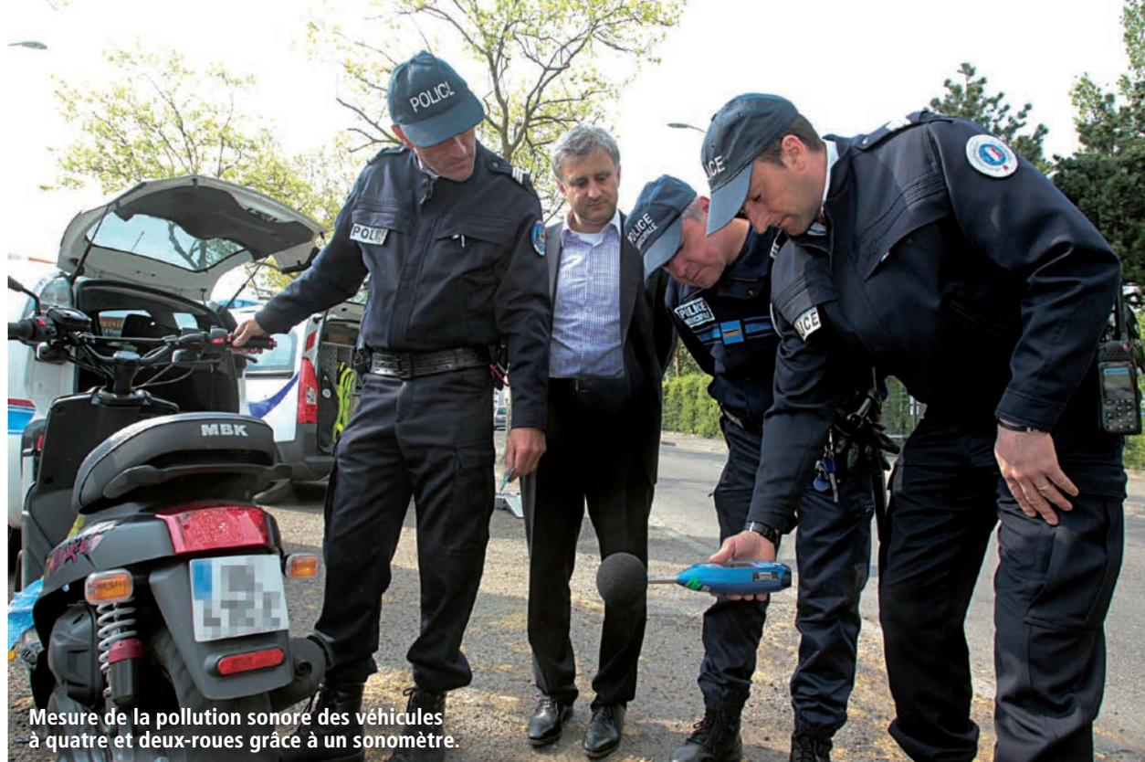
Mesure de la pollution sonore des véhicules à quatre et deux-roues grâce à un sonomètre.
