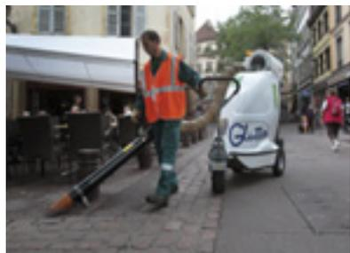
■ Depuis le début 2010, la Ville s'est dotée d'un aspirateur électrique de trottoir : le Glutton. Ce matériel est silencieux, et non polluant. L'engin est autotracteur et dispose d'une cuve à déchets de 240 litres.
