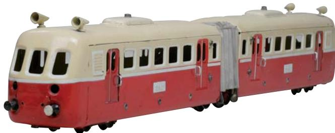
Grand autorail JEP (France), mesurant 69 cm. A l'échelle 0. Moteur électrique 20 volts, éclairage intérieur et portes d'extrémités ouvrantes. Il reproduit assez bien les fameux T.A.R (Trains Automoteurs Rapides) du « Nord ». Il figura dans le catalogue JEP de 1935 à 1957.
