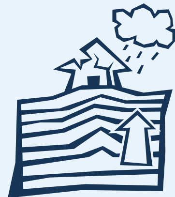
Pluie Gonflement des argiles
